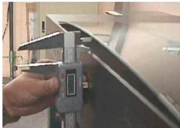
Figura 24: Imagen de inspección de calidad – Longitud de flecha
