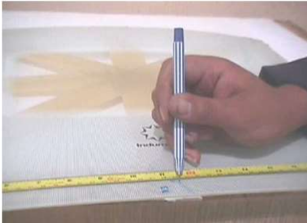
Figura 29: Imagen de medición de longitud de vidrio
