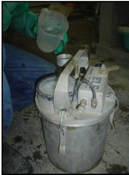
**Foto 8. Medición del contenido de aire.**
