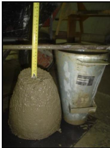
**Foto 6. Medición del Slump**
