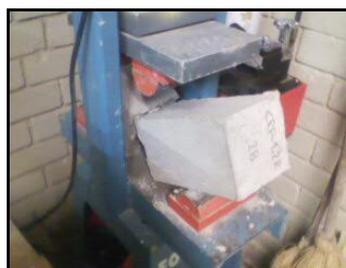
**Foto 11. Ensayo a flexión.**
