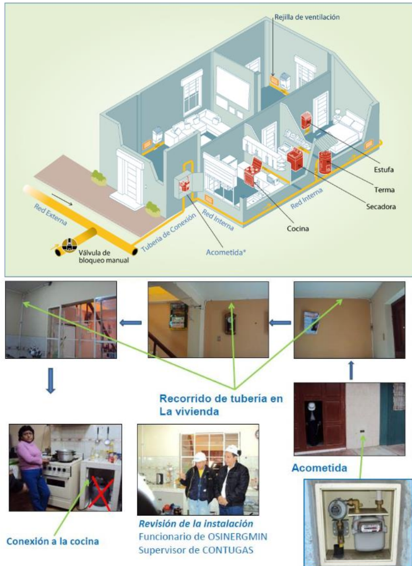
Figura 32. Instalación Interna de Gas Natural
