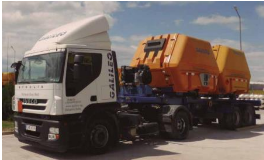
Figura 25. Tráiler VST para dos MAT
