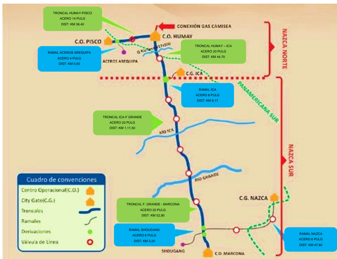
Figura 10. Elementos de seguridad del sistema de distribución de gas natural en el departamento de Ica Fuente: Tomado de “Reporte de progreso 2012” por Contugas, 2012.
