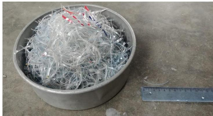
Figura 12: Fibras de PET reciclado con 5cm de longitud
