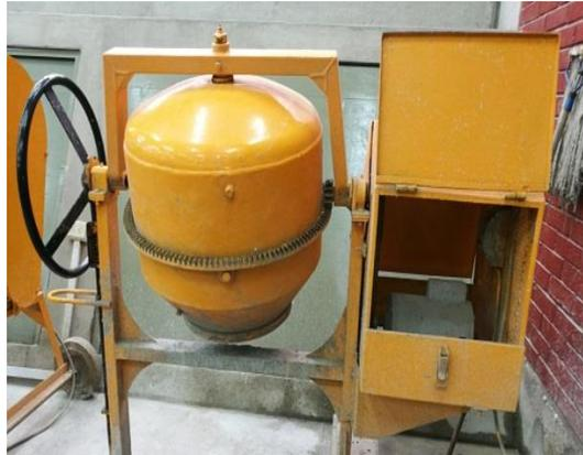
Figura 5: Mezcladora de concreto
