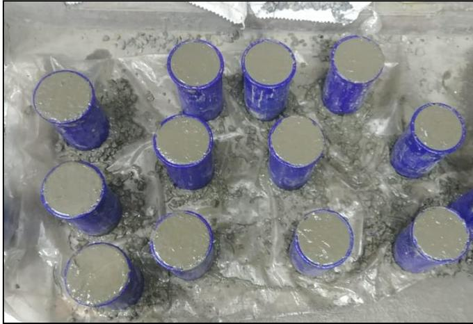
Figura 14: Muestreo de probetas
