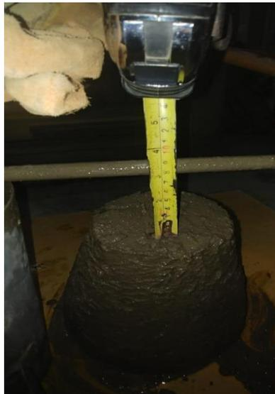
Figura 17: Ensayo de Asentamiento de Muestra DPET-1%
