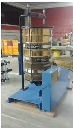
Figura 1: Tamizador eléctrico
