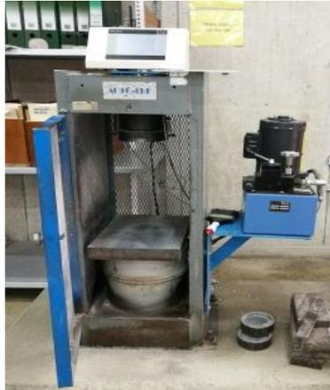
Figura 7: Máquina de compresión
