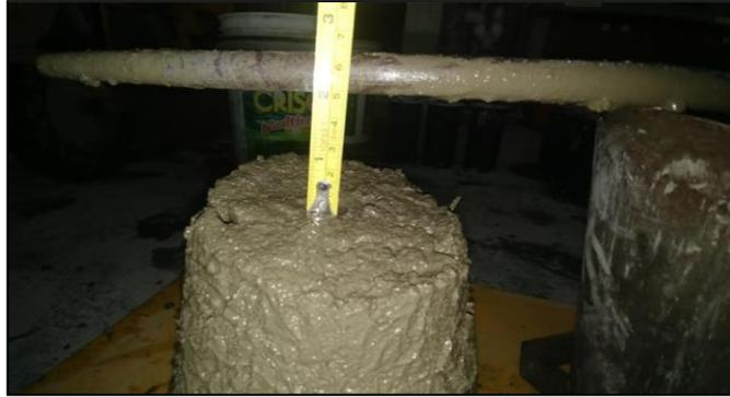
Figura 16: Ensayo de Asentamiento de Muestra DPET-0.5%
