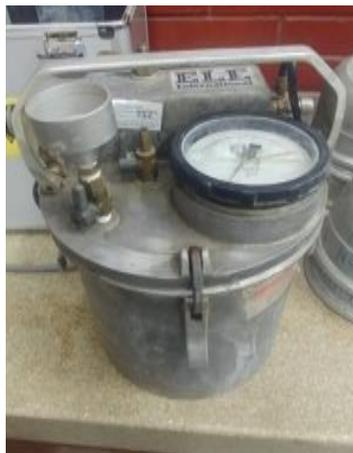
Figura 8: Medidor de contenido de aire
