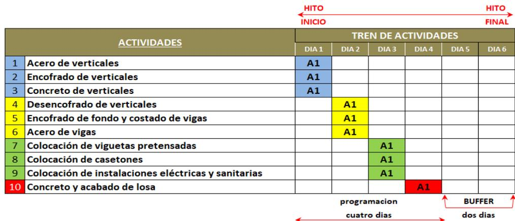
Figura N° 47.- Creación del buffer en la cadena
