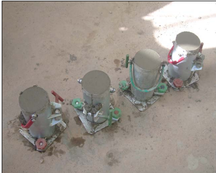
MOLDEO DE TESTIGOS CILÍNDRICOS PARA ROTURAS
