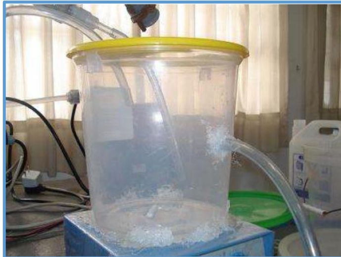
Figura 23: Reactor usado para la neutralización de pH.
