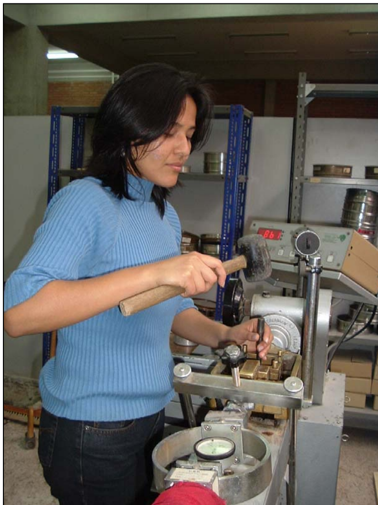
REALIZANDO ENSAYOS DE CORTE DIRECTO EN EL LABORATORIO URP
