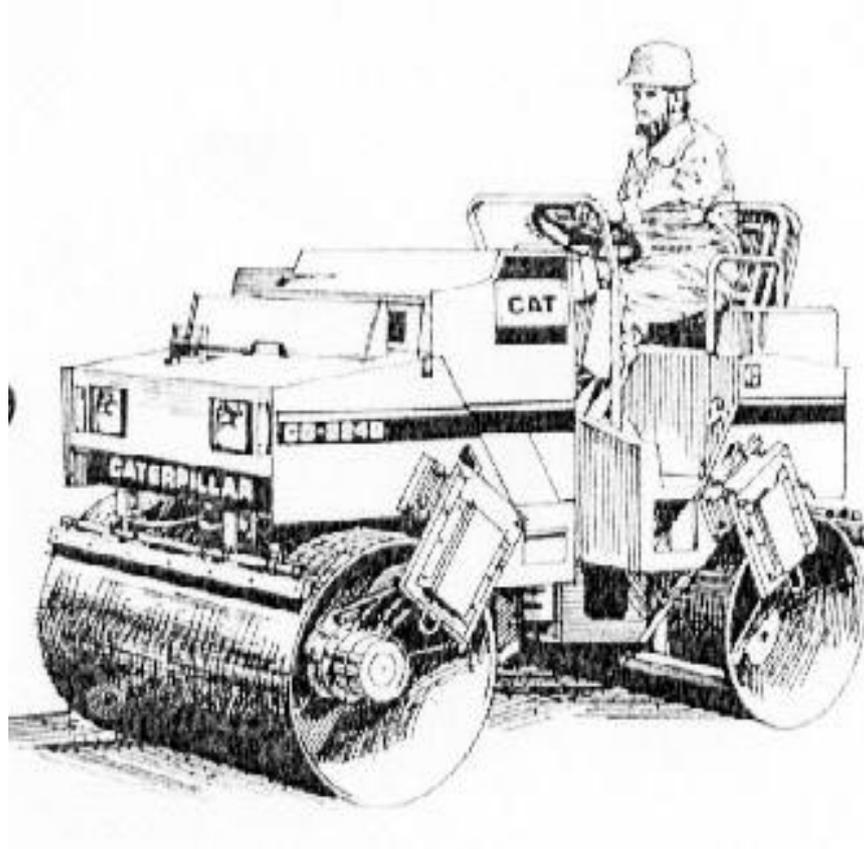
Figura III-13 Rodillo con ruedas de acero
