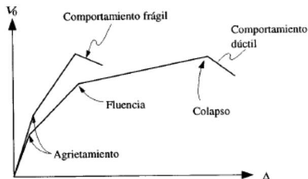
Figura 10: Relación carga-deformación de una estructura
