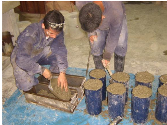
Probetas vaciado que serán ensayadas a los 7, 14 y 28 días
