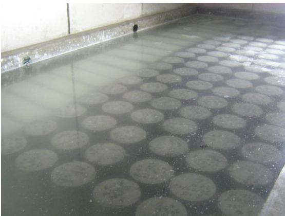
Curado de las probetas y vigas en la cámara de curado
