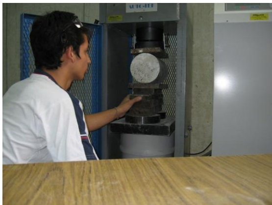
Ensayo a Tracción por Compresión Diametral
