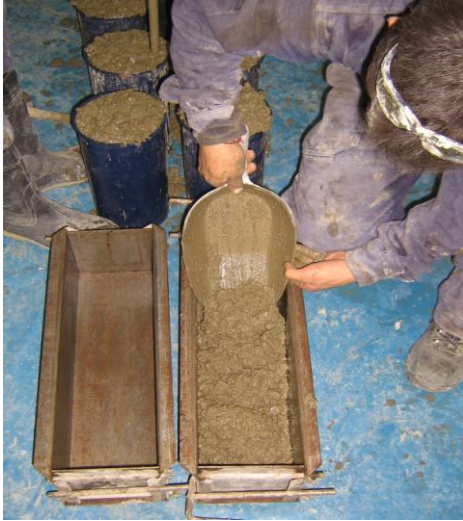
Vaciado de las vigas que serán ensayadas a flexión
