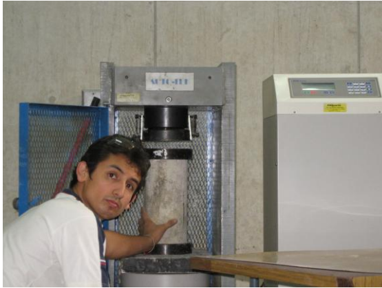
Ensayo de compresión en la prensa automática
