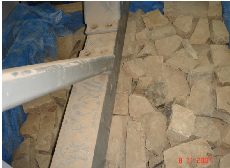
Figura 7.5: Muestra A y B del muro empírico en laboratorio de la Universidad Ricardo Palma.
