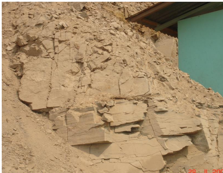
Figura 7.19: Roca estratificada natural en la zona de colapso.
