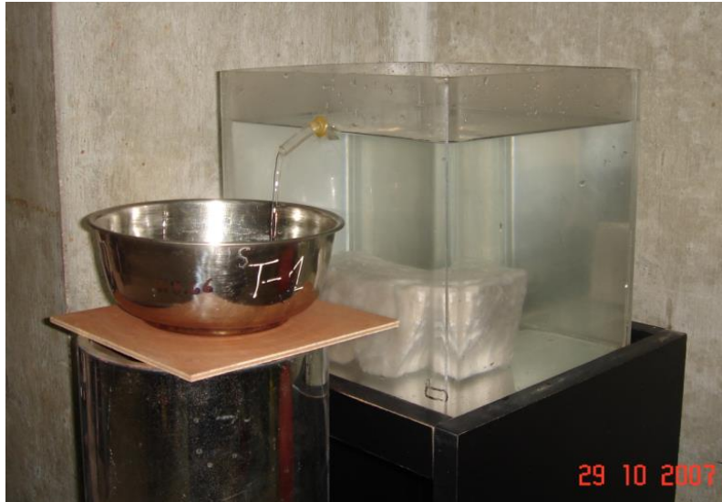
Figura 7.7: Equipo para Ensayo del Método de la Parafina por Sifón.
