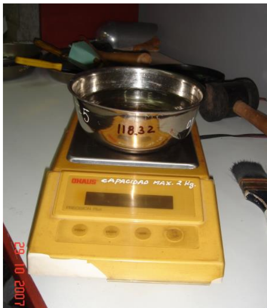
Figura 7.8: Peso del agua expulsada por la muestra.
