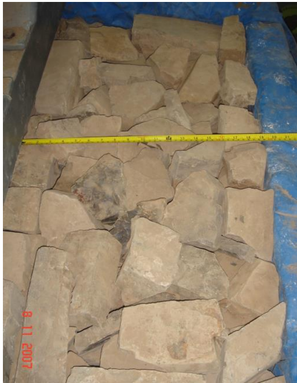
Figura 7.3: Vista en planta de muro empírico en laboratorio de la Universidad Ricardo Palma.
