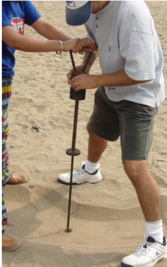
Figura 2.2: Ensayo de Penetración de Barra. A.H. Los Angeles, Ventanilla.
