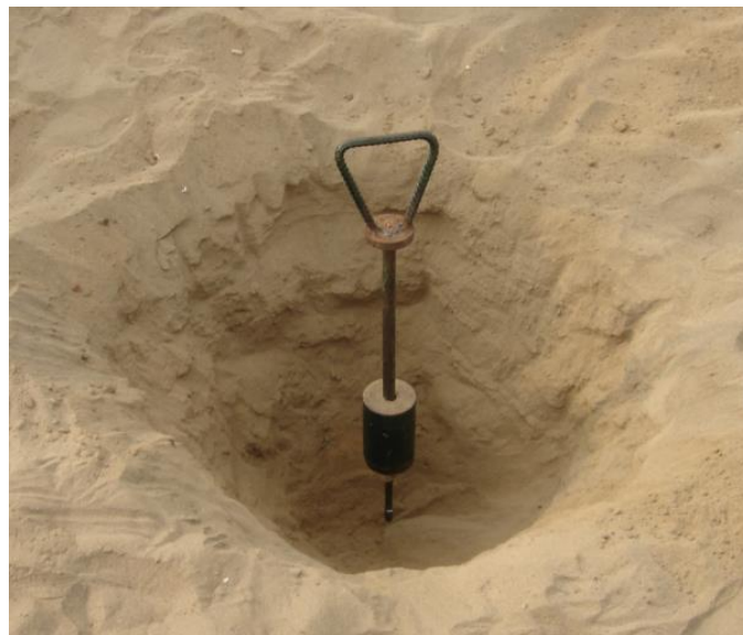
Figura 2.3: Ensayo de Penetración de Barra. A.H. Los Angeles, Ventanilla.
