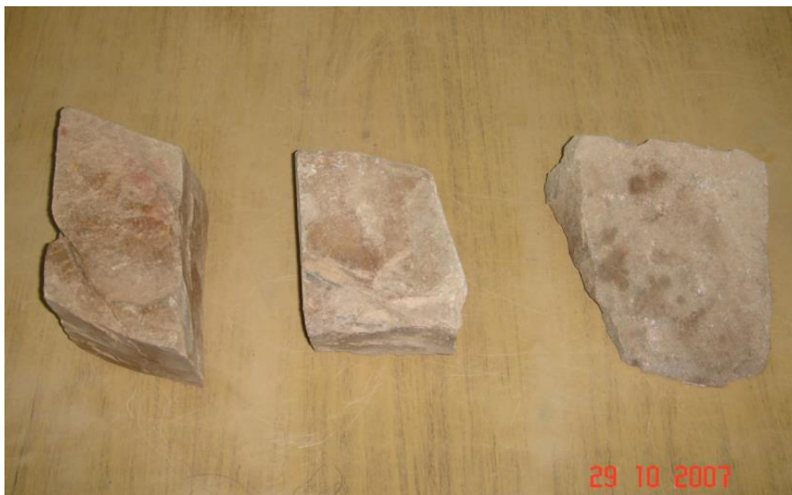
Figura 7.6: Muestras de piedra del muro para ensayarlos por el Método de la Parafina por Sifón.
