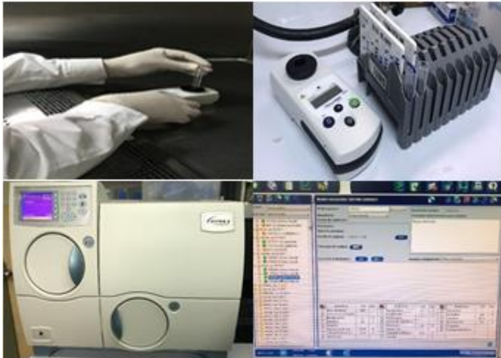
Fig. N°7. Preparación del inóculo, pruebas bioquímicas, sensibilidad bacteriana y lectura de los resultados utilizando Vitek ® 2.
